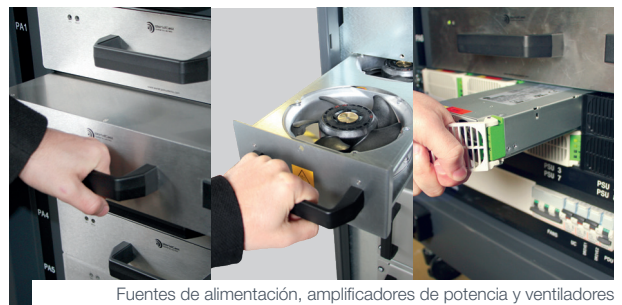
Fuentes de alimentación, amplificadores de potencia y ventiladores redundantes e intercambiables "en caliente"
